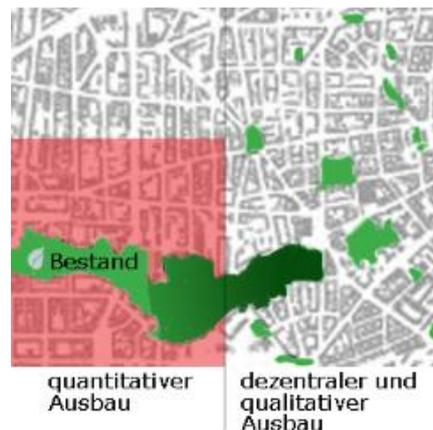
Abb. 3: Schematische Darstellung alternativer Grünentwicklung. Links mit Stadtstruktur inkompatibler Grünflächenbedarf (rot), rechts Anpassung durch qualitative Aufwertung (dunkelgrün) und kleinteilige Strukturen auf zu identifizierenden Freiflächen.
